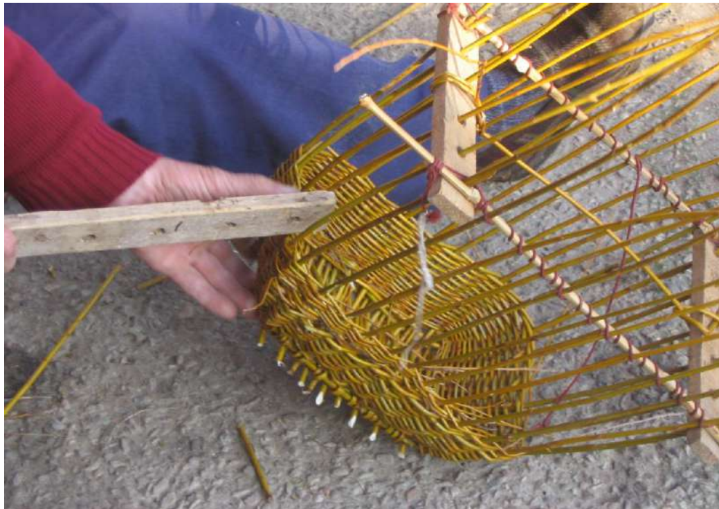
Fot. 25: Apretando la trama de las paredes golpeando con una tabla.
