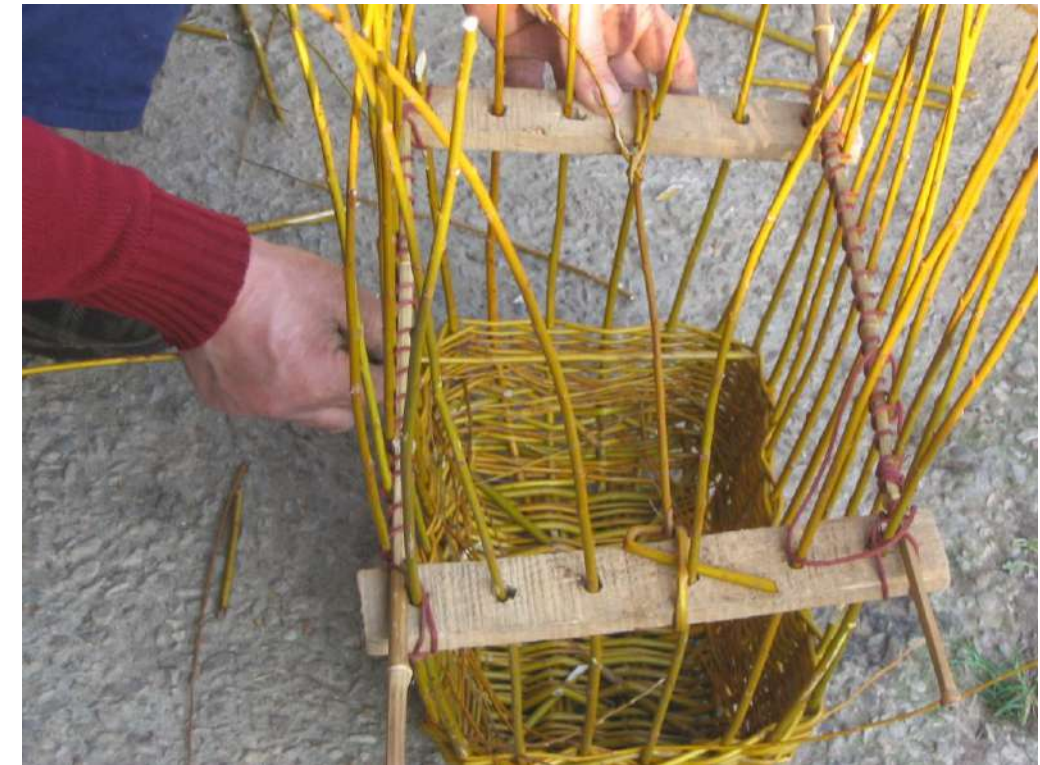
Fot. 13: Midiendo con una blima el ancho de la pieza.
