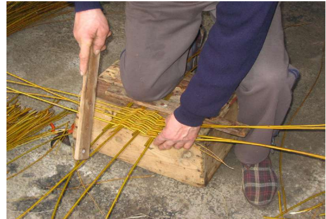
Fot. 11: Apretando la trama del culo con una tabla.
