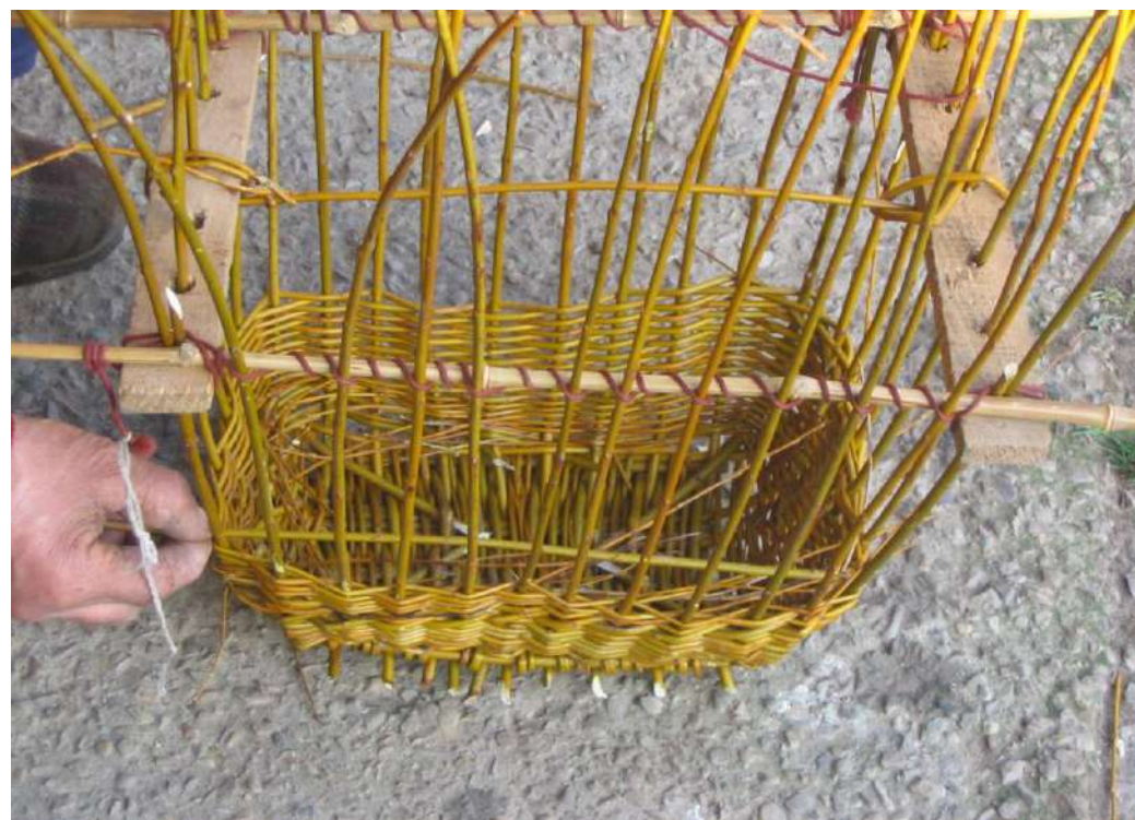
Fot. 26: Comprobación con una blima , de la igualdad de los lados.
