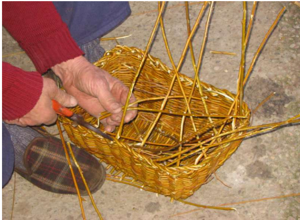
Fot. 30: Recortando los sobrantes del cordón .
