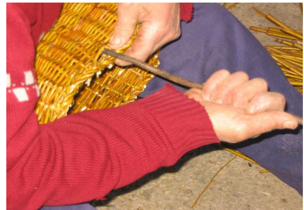
Fot. 24: Abriendo espacio entre la trama con el hierro, para introducir el asa .
