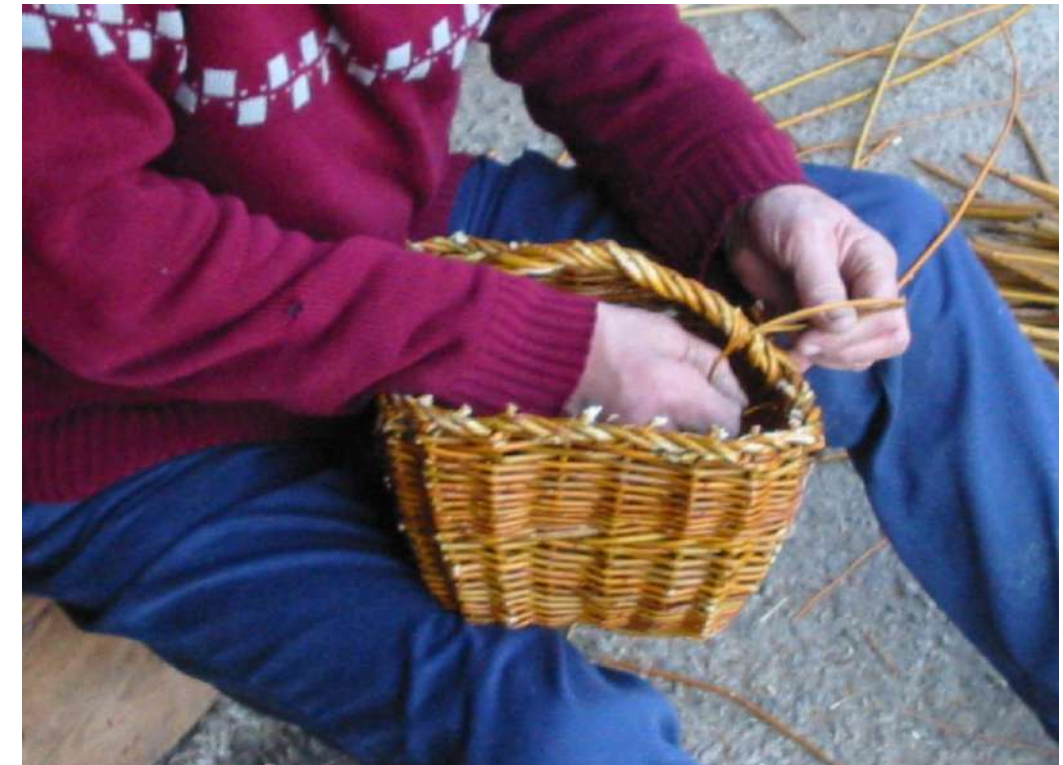
Fot. 25: Trenzando el asa de la pieza.
