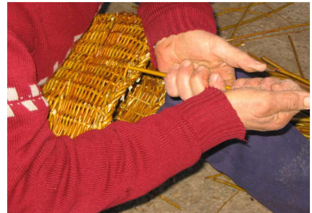
Fot. 36: Introducción de unos de los extremos del asa en la trama.
